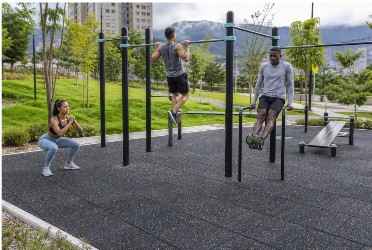
Ilustración 5. Zona de calistenia sobre losetas modulares de caucho SBR.
