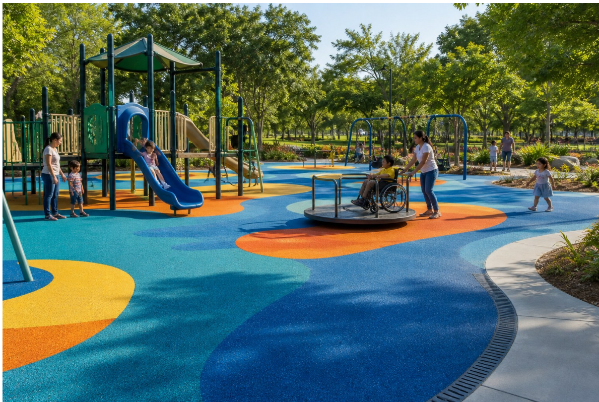
Ilustración 6. Parque infantil inclusivo con superficie continua de seguridad SBR + EPDM.
