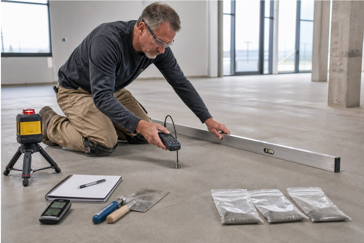
Ilustración 2. Verificación de planitud, humedad y condiciones de la base antes de instalar.
